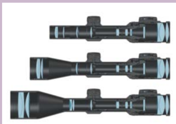
La sezione dei cannocchiali Leica Magnus
