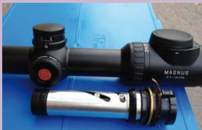
Il cannocchiale con il suo tubo interno
